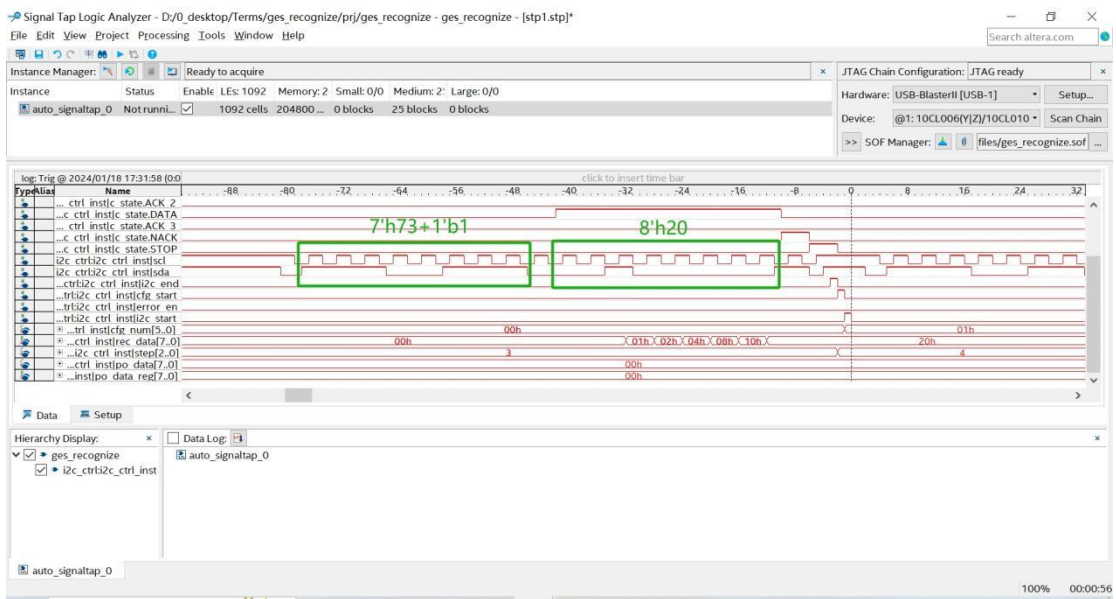
图 1.55 读取 0x00 寄存器数据信号波形图 (2)
